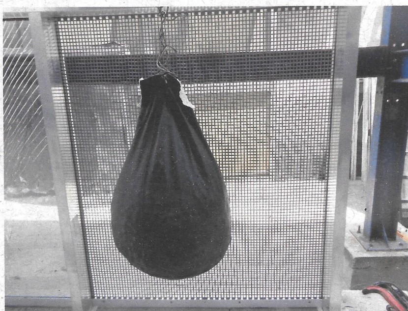
Foto nº. 04 Verificação da resistência a impactos: Módulo em chapa perfurada.
