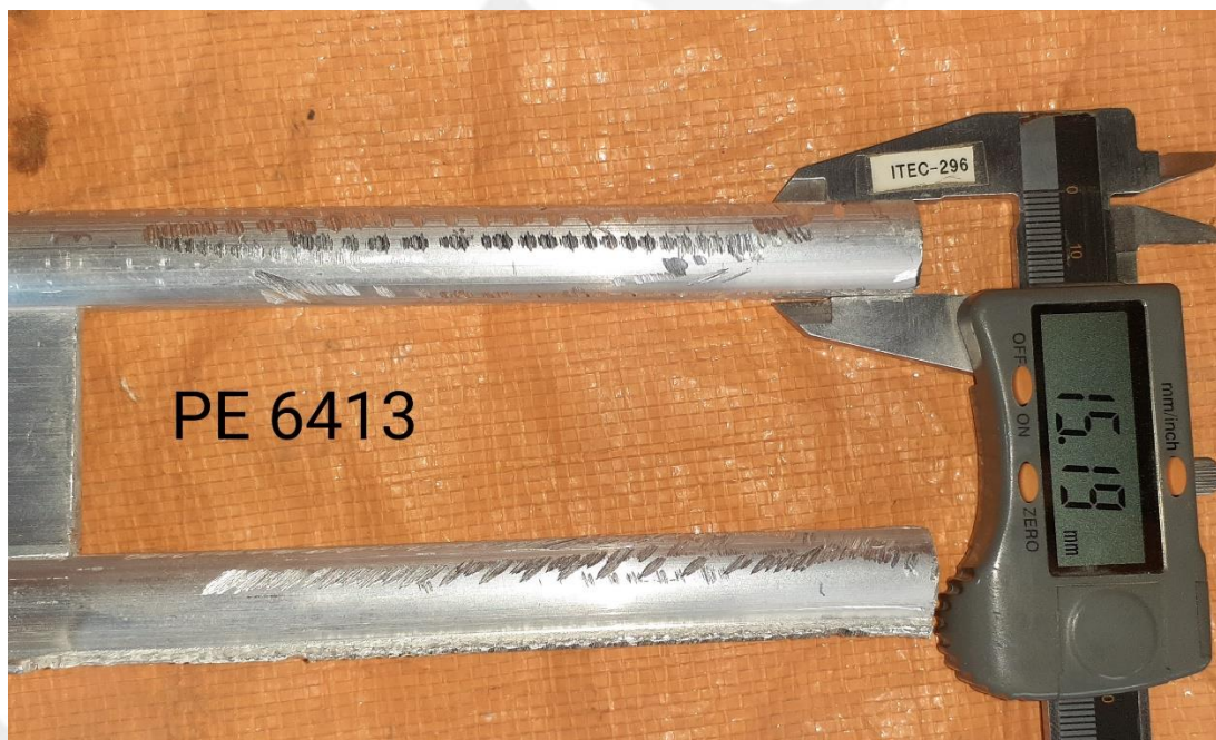
Foto nº. 04 Instalação do protótipo: diâmetro dos pontaletes
