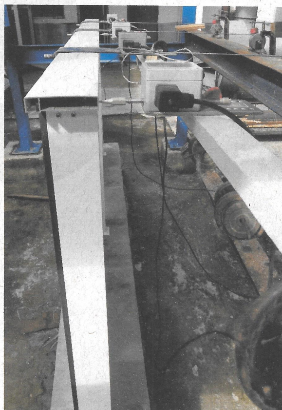
Foto nº. 01 Determinação do esforço estático horizontal: Carga de uso
