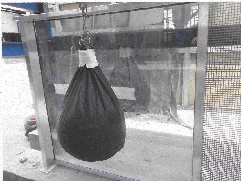
Foto nº. 03 Verificação da resistência a impactos: Módulo em vidro.
