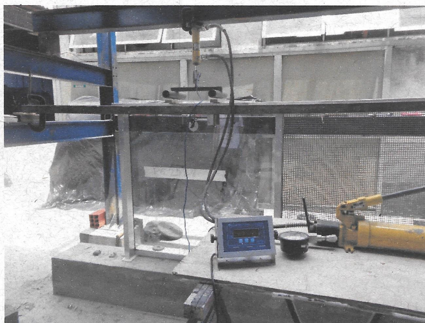
Foto nº. 02 Determinação do esforço estático vertical
