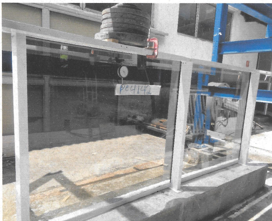
Foto nº. 03 Determinação do esforço estático vertical.
