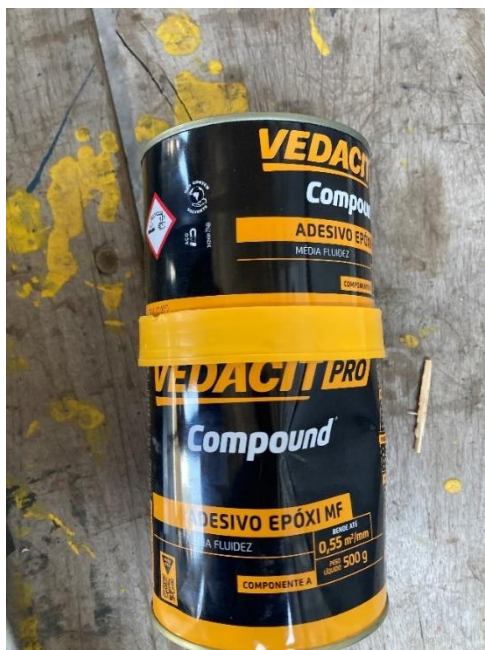
Foto nº. 05 Chumbador químico utilizado
