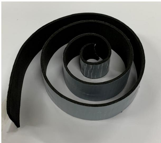
**Foto 11:** Fita auto adesiva de borracha de seção de (25 X 2,0) mm utilizada.
